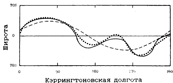
Рис. 4. Синоптическая карта конфигурации нейтральной линии на поверхности источника (сплошная линия) для кэррингтоновского оборота № 1800 (март-апрель 1988 г.). Штриховая линия — сечение сферической поверхности источника средней плоскостью ГТС; пунктирная линия — сечение гиперболическим параболоидом.
